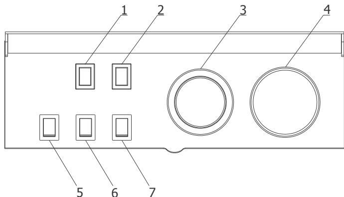
3. **Kotlovým termostatem** se nastavuje teplota topné vody v rozsahu 55 °C až 90 °C. Nedoporučuje se nastavovat nižší teploty vzhledem k zvýšené produkci kondenzátu na vstupu výměníku.
