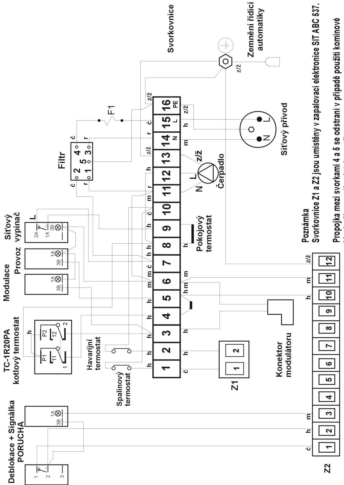
**Elektrické schéma kotlů Therm E/B**
