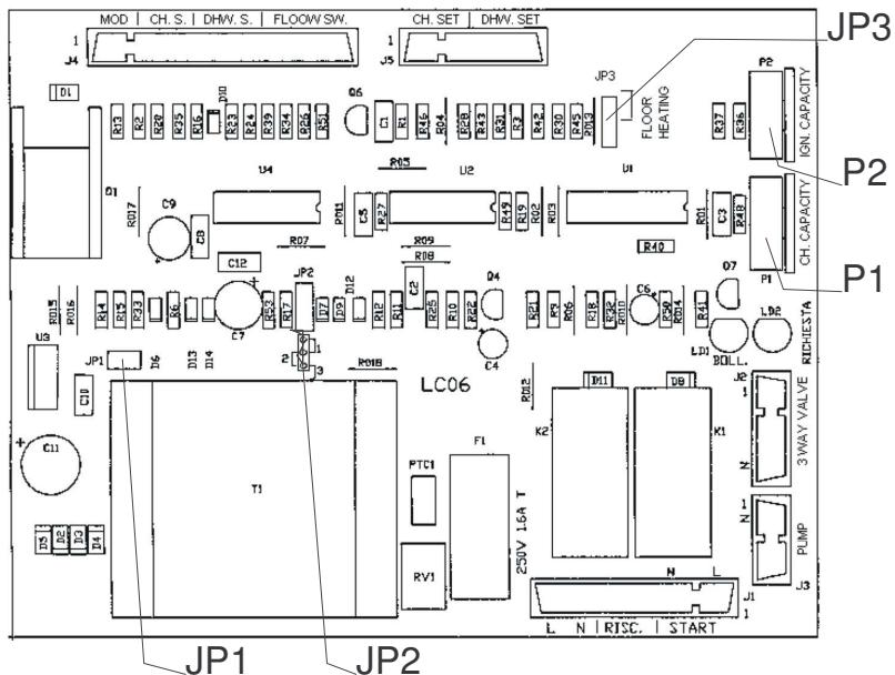
**JP 3** - volba otopného systému = radiátory / podlahový (radiátory propojeno). Vzhledem k litinovému výměníku se doporučuje nechat JP3 spojen.
