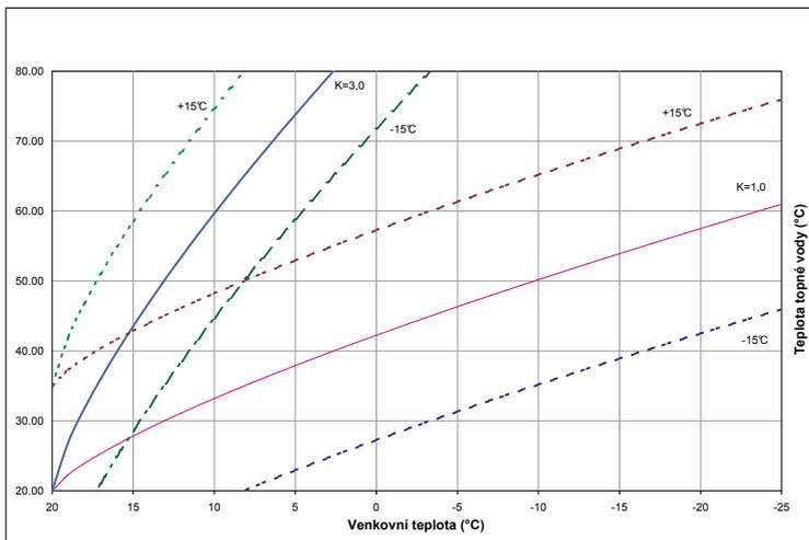
Vypočtená teplota topné vody je omezena na max.  $80^\circ\text{C}$ . Pokud se vypočtená teplota pohybuje v rozsahu  $20 \div 35^\circ\text{C}$  je požadovaná teplota omezena na minimální teplotu kotle, tj.  $35^\circ\text{C}$  a je spuštěna funkce periodického spouštění kotle ve fixním intervalu 15 minut a proměnnou dobu chodu na  $35^\circ\text{C}$  dle vztahu:
