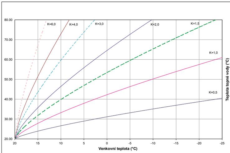
Po kontrole teploty vytápěného prostoru (cca za 24 hodin) lze provést upřesnění nastavení dle vašich požadavků na tepelnou pohodu. Vlivem ekvitermní regulace budou nadále kompenzovány změny venkovní teploty a nastavená hladina teploty vytápěného prostoru bude udržována automaticky na konstantní hodnotě.
