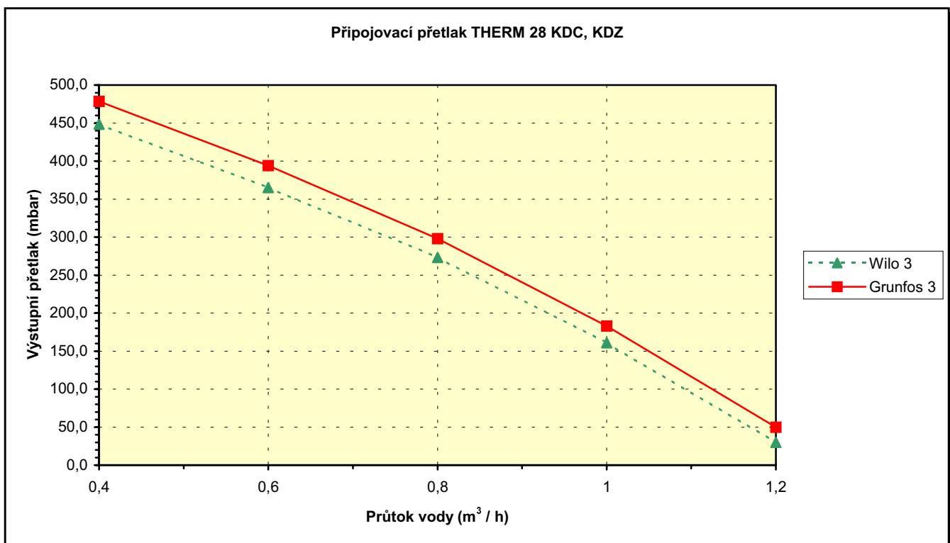
**Upozornění:** Křivky použitelných připojovacích přetlaků topné vody jsou zpracovány na čerpadla Wilo 25/70 a Grundfos 15/60 na nejvyšší regulační stupeň. Vzhledem k rychlosti ohřevu zásobníku u kotlů THERM 28 KDZ nedoporučujeme výkon čerpadla snižovat.
